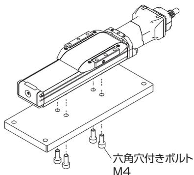
※ねじ込み長さが6mmより大きい場合、内部の部品に干渉するため、注意してください。
