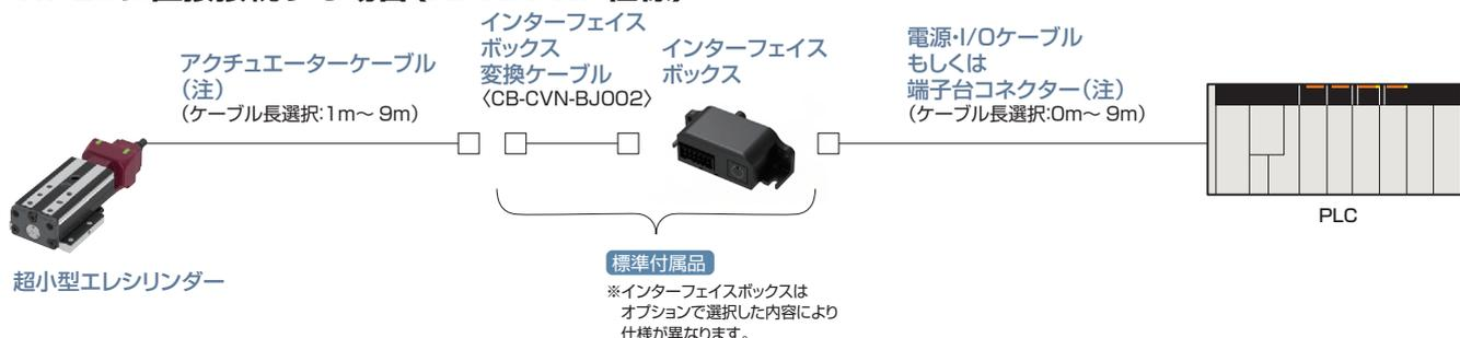
(注)アクチュエーターケーブルと電源・I/Oケーブル(端子台コネクタの場合はお客様にてご用意するケーブル)の合計ケーブル長が10m以下になるように選定してください。
