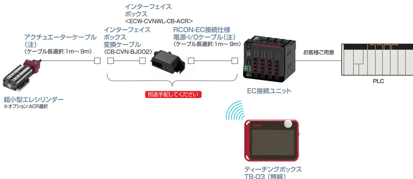
(注)アクチュエーターケーブルとRCON-EC接続仕様電源・I/Oケーブルの合計ケーブル長が10m以下になるように選定してください。
