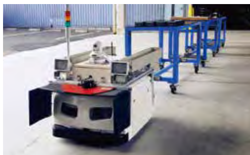
工場 建屋間搬送
